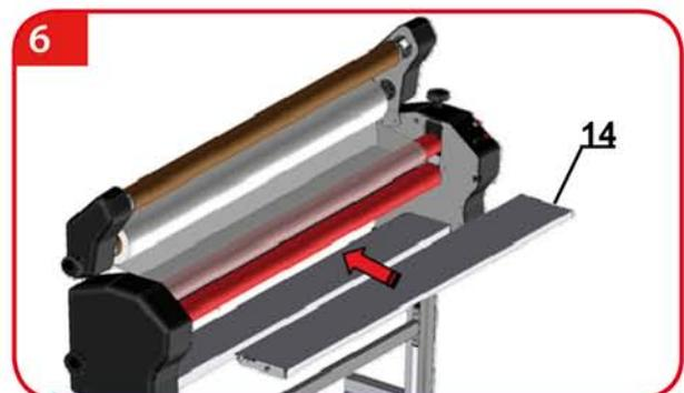
7. Um zu vermeiden, dass das Applikationstape auf der unteren Walze kleben bleibt, führen Sie ein Vinyl durch mit der gleichen Breite oder breiter als das Applikationstape.
