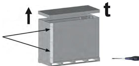
Lösen Sie die 4 Schrauben an jeder Halteklammer und entfernen Sie die 4 Klammern.
