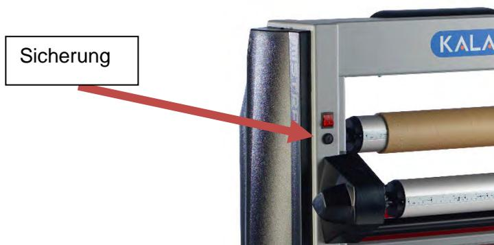
Austausch der Sicherung auf der elektronischen Leiterplatine:
