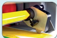
Antistatische Schnur mit Magnethalterung
